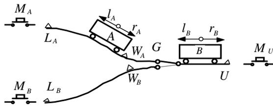
Se trata de controlar el sistema de transporte de una mina que se muestra en la figura. Se controlan los movimientos de los vagones (avance hacia la derecha (r), avance hacia la izquierda (l) y parada (s), en base a las señales que se establecen con los pulsadores en las estaciones terminales ( $M_A, M_B$  y  $M_U$ ), y de los sensores de paso por determinados puntos de las
