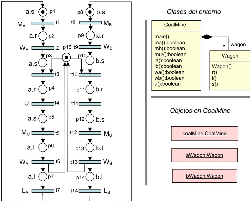
El objetivo de diseño que se propone es diseñar un conjunto de clases que corresponden a los elementos básicos de la RdP: RdP, Transición, Place, Token, que permitan construir la aplicación de forma automática por la simple invocación de la aplicación desde el sistema operativo:
