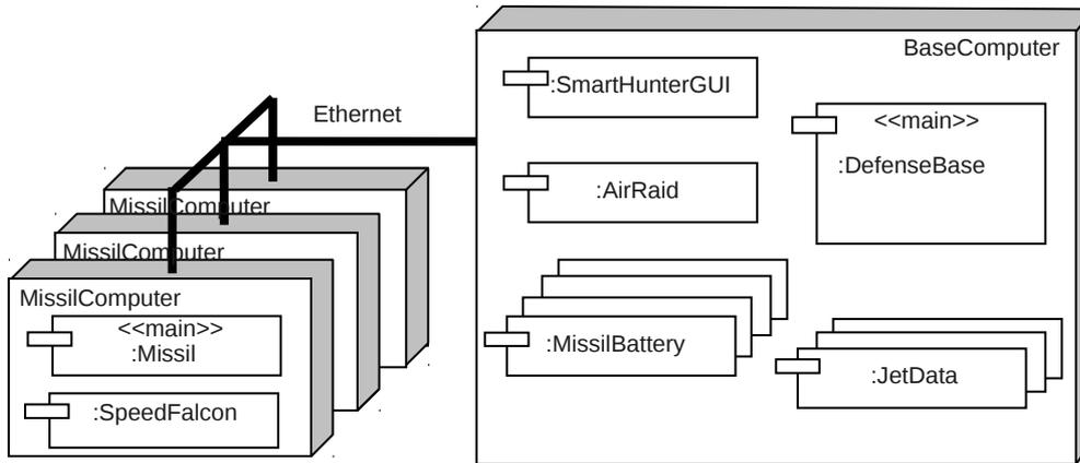
Se considera que todo el software del sistema de defensa está instalado en un único computador, mientras que se distribuye en cada misil, tanto el software de control del hardware (SpeedFalcon), como el software de conducción del misil (Missile).
