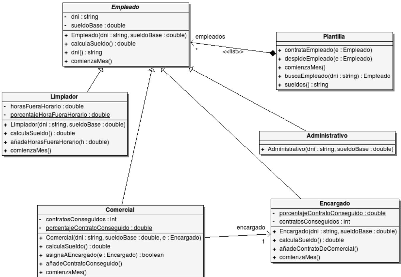
Solución en la que cada Encargado tiene una referencia a su comercial. Cada vez que se asigna un contrato a un Comercial (con su método añadeContratoConseguido()), este método internamente llama al método de Encargado añadeContratoDeComercial().
