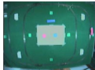
Se han definido varias zonas sobre las vías en las que va a ser de interés detectar la presencia de un tren en ella. Estas zonas se han determinado mediante edición manual de una
