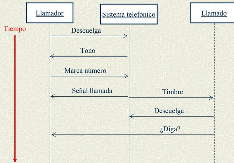
En la figura se muestra un ejemplo de diagrama de secuencias que describe el proceso de comunicación de dos personas (Llamador y llamado) a través de una línea telefónica.
