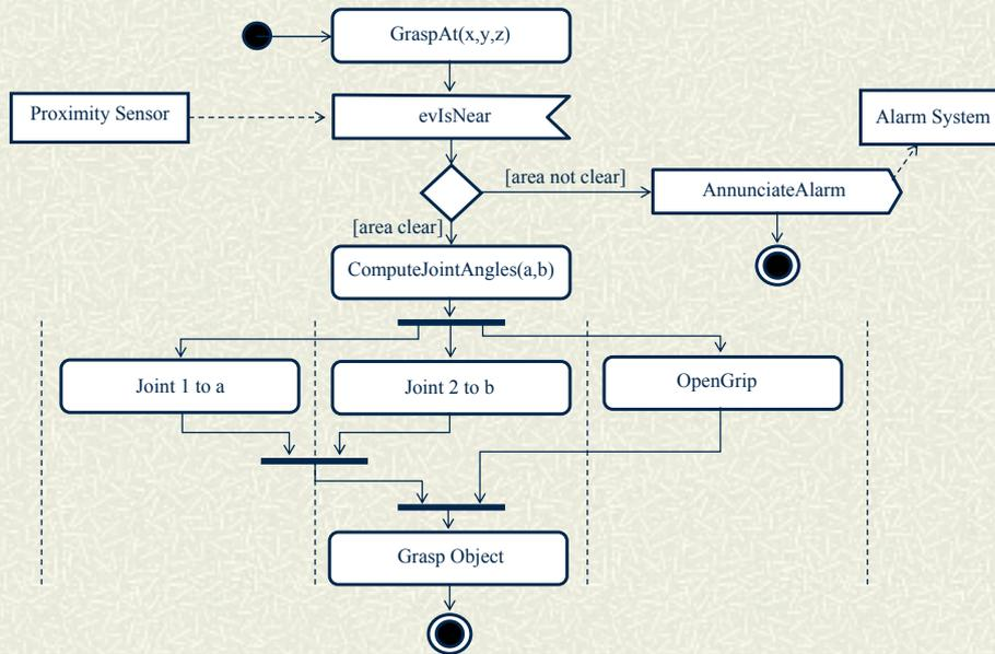
Ejemplo Operación de un robot: Modela el proceso de cogida de un objeto mediante un brazo robotizado con una pinza.
