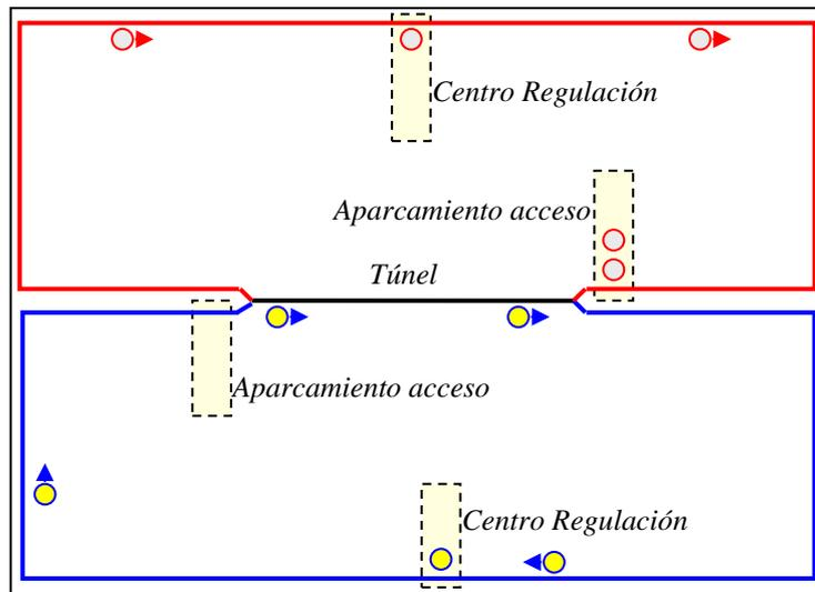
Cada tramo ferroviario tiene un *centro de regulación*, en el que los trenes se aparcan temporalmente a fin de regular sus tiempos de salida y con ello conseguir un tráfico uniforme. Para ello se permiten salir los trenes de los puntos de regulación con los intervalos de tiempo que corresponden a dividir el tiempo teórico de recorrido por el número de trenes. Denominamos tiempo teórico de recorrido al tiempo que tarda en recorrer el tren en recorrer su circuito sin paradas.
